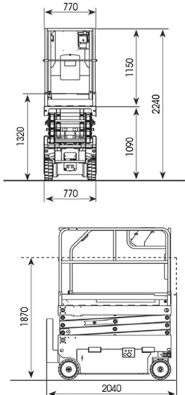
**PANTOGRAFI ELETTRICI SENZA STABILIZZATORI****DIAGRAMMA DI LAVORO**
